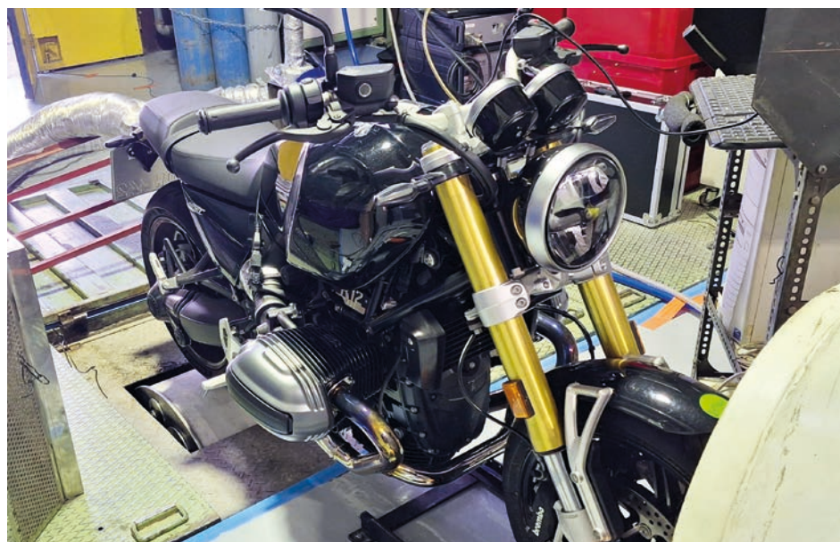
Kuva 1. Mittaukset toteutettiin laboratorio-olosuhteissa hyödyntäen alustadynamometriä.
