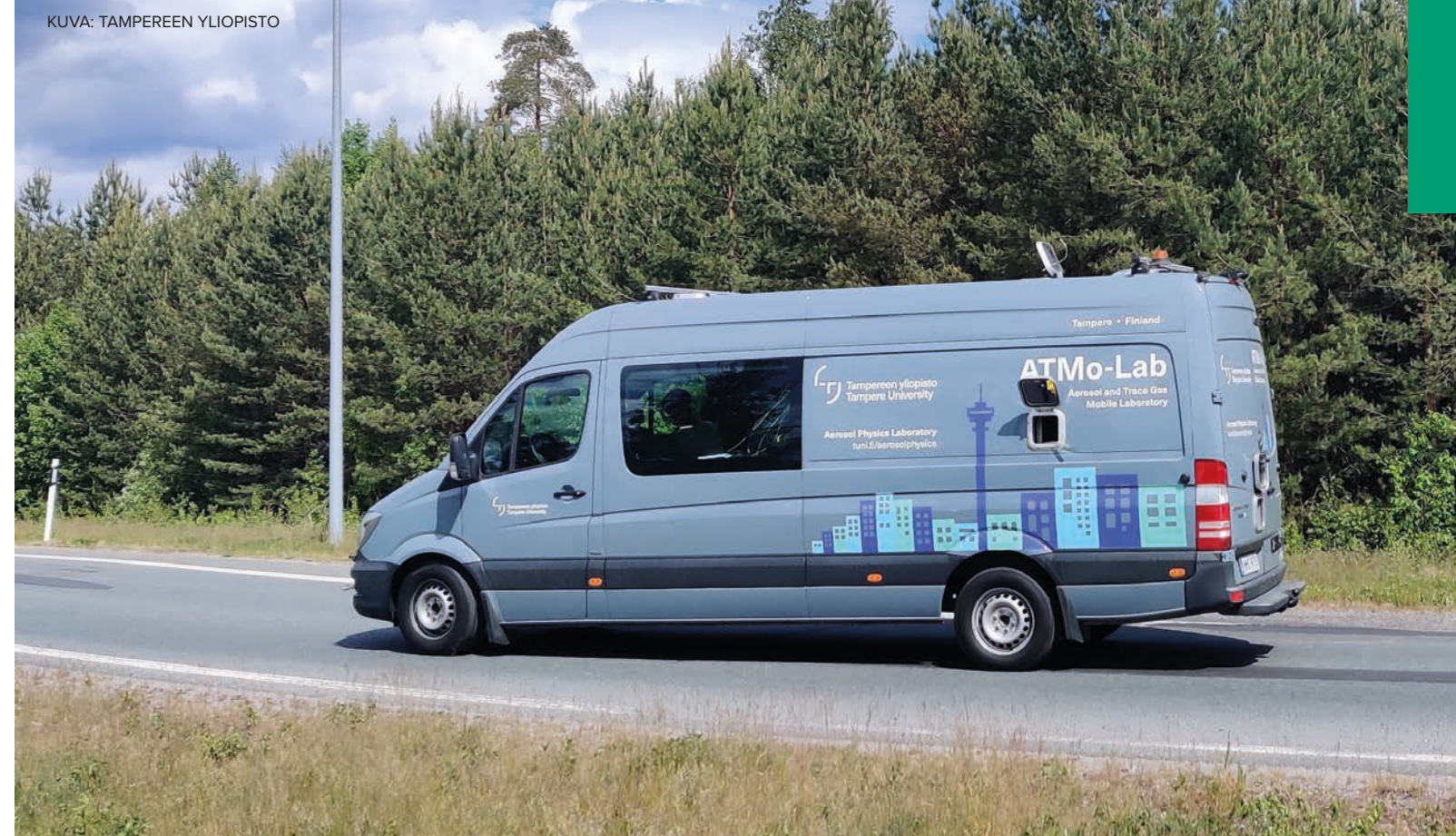
Kuva 2: Moottoritieajomittauksia toteutettiin Tampereen yliopiston Aerosolien ja hivenkaasujen mobiililaboratoriolla (Aerosol and Trace Gas Mobile Laboratory, ATMo-Lab).
