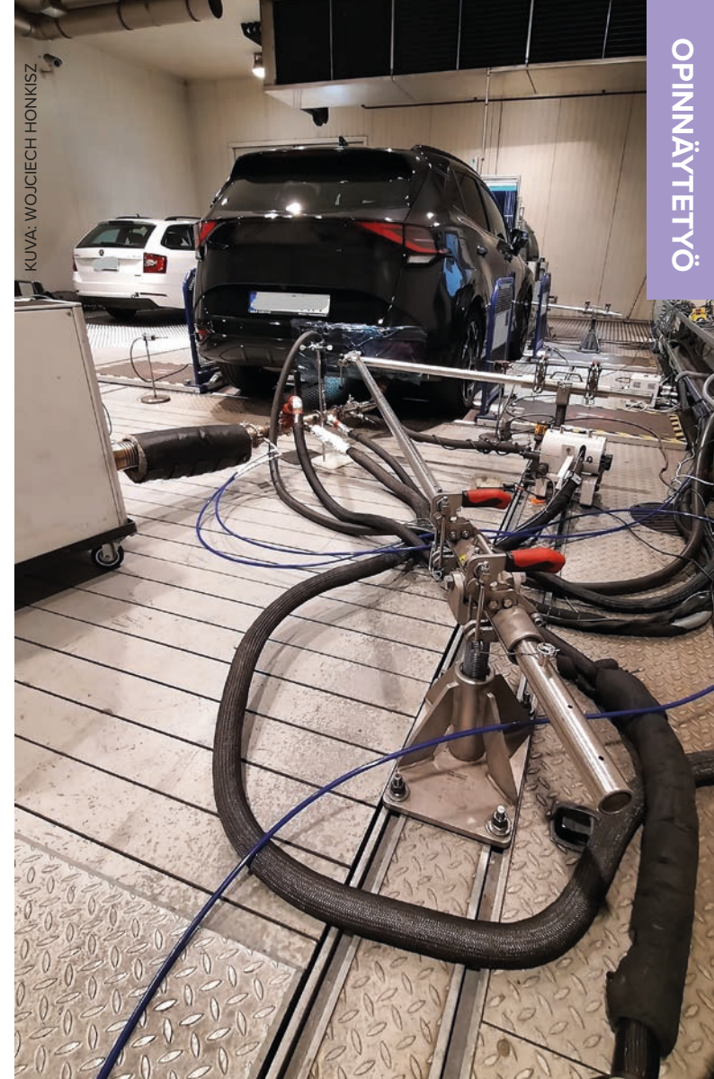
Kuva 1. Diplomityö tehtiin osana EU-rahoitteista PAREMPI-projektia, jossa tutkittiin esimerkiksi henkilöautojen pakokaasupäästöjä ajamalla autoja alustadynamometrillä. Kuvassa on mittaukset käynnissä Puolassa, Bosmalin autotestauslaboratoriossa.
