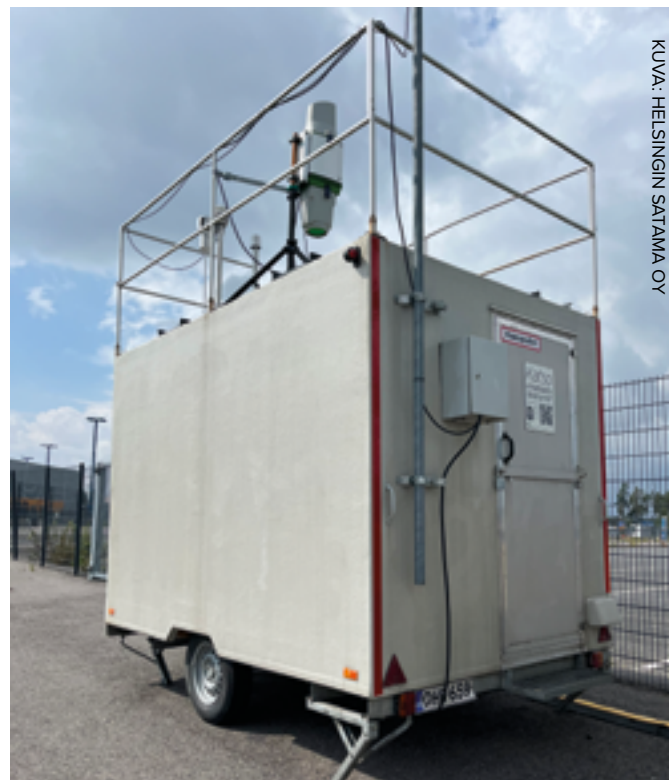
Kuva 3. HSY:n siirrettävä ilmanlaadun mittausasema Vuosaaren satama-alueella vuonna 2024.
