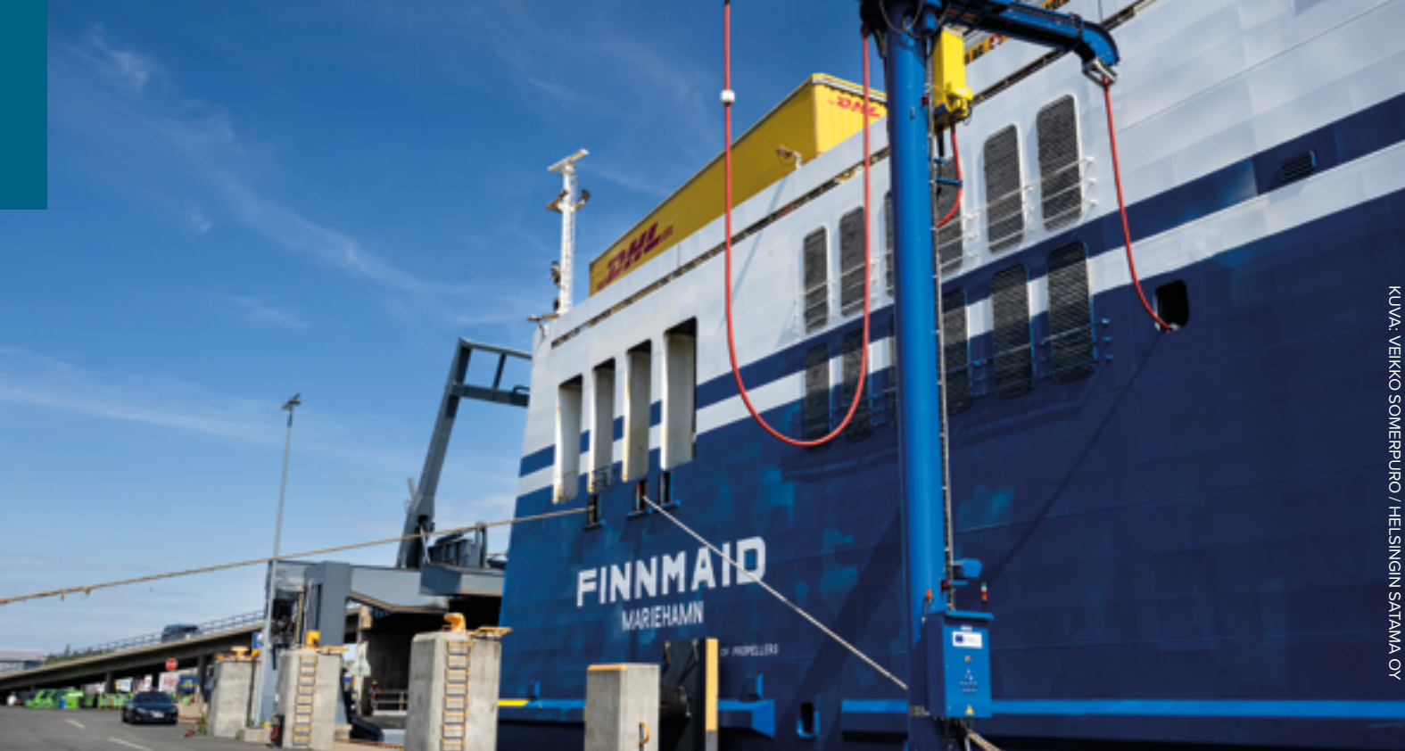
Kuva 1. M/S Finnmaid kiinnitettynä maasähkijärjestelmään Vuosaaren sataman C-laiturilla.
