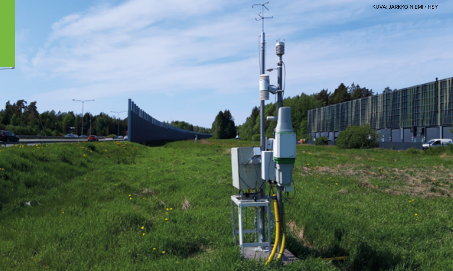
Kuva 2. Pylväissä mitattiin ilmanlaatua ja säätä monilla erilaisilla laitteilla: AQT530 ja GMP343 (Vaisala), AQ Urban (Pegasor), Par-tector (Naneos), A30 CPC (Airmodus), 1720 CPC (Brechtel), AE51 (AethLabs), ObservAir (DSTech), HOPE-hankkeen sensori, typpi-dioksidin passiivikeräin, 3D-anemometri ja sääasema.
