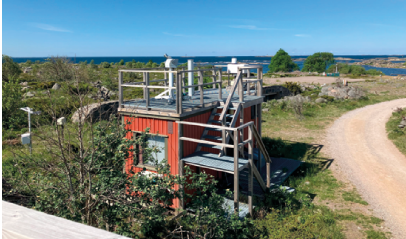
Toinen ilmanlaatuaseman mittauskonteista, jossa näkyvät muun muassa: Vallitsevan sään anturi, jonka pohjalta kuulemme radion merisään kertovan "Sää rannikkoasemilla tänään....Utö, näkyvyys 50 km...". Lisäksi kuvassa sunphotometri, joka mittaa auringosta tulevaa säteilyä eri aallonpituuksilla ja joka toimii satelliittimittauksen referenssinä. Kolmantena kuvassa näkyy HALO-lidar, joka tuottaa 3D tuulikentän Utön yläpuolella ja ympärillä. Kuvan kontissa sijaitsevat myös radioaktiivisuusmittauslaitteet.
