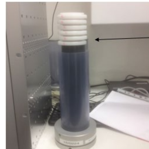
Kuva 6. Puhtaat suodatinkiekot laitetaan vasemmanpuoleiseen säiliöön.
