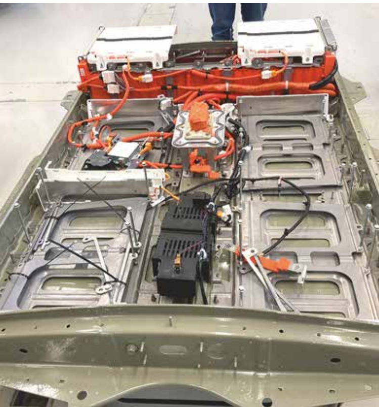
Sähköauton pohja kannattelee auton akkujärjestelmää.
