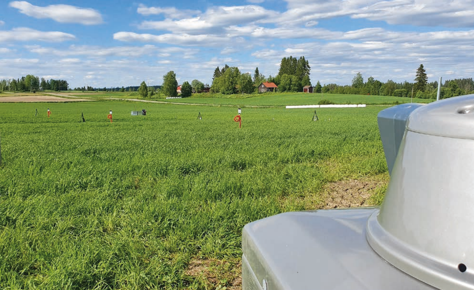
Kuva 3: Esimerkki PelloTomo-projektin mittausasetelmasta. Etualalla kuvassa Mirico Orion Dual Gas ( \text{CO}_2 , \text{CH}_4 )-laserlähde ja sensori. Laserlähde skannaa kolmijalkojen päälle pellolle aseteltuja peilejä. Peilien välisiltä palstoilta suoritetaan kammiomittauksia. Lisäksi pellon keskellä (kuvan ulkopuolella) on pyörrekovarianssimittalaitteisto.
