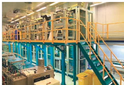
Kuva 3. Painetut orgaaniset, polymeeripohjaiset aurinkokennot ja niiden rullalta-rullalle-valmistus. Kuvan laitteisto osana Teknologian tutkimuskeskus VTT:n pilot-mittakaavan valmistusympäristöä.
