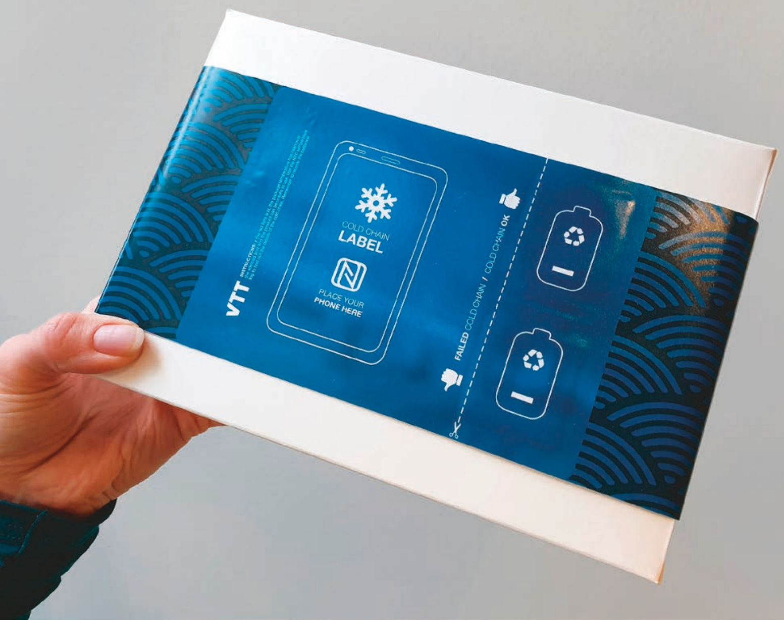
Kuva 5. Energiaomavarainen ja etäluettava olosuhteita monitoroiva älyetiketti pakkaukseen. Älyetiketti demonstroidaan osana ECOtronics-projektin valmistuskonseptia.
