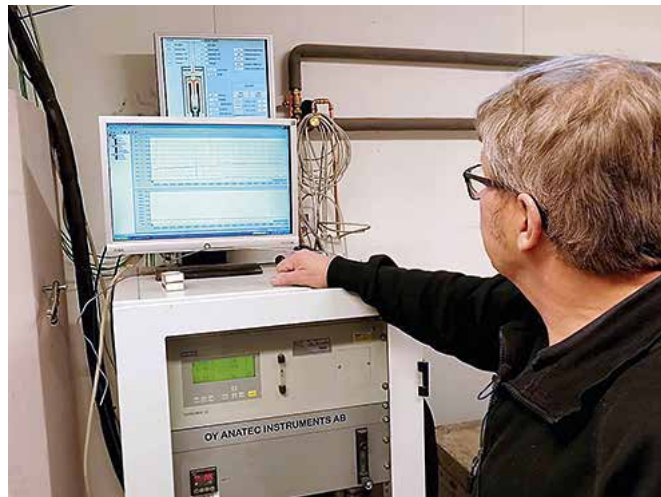
Vesa esittelee Warma-Uunien laboratoriomittauksia, josta saadaan tietoa tulisijan häkä- ja hiilidioksidipäästöistä sekä jäännöshapasta.
