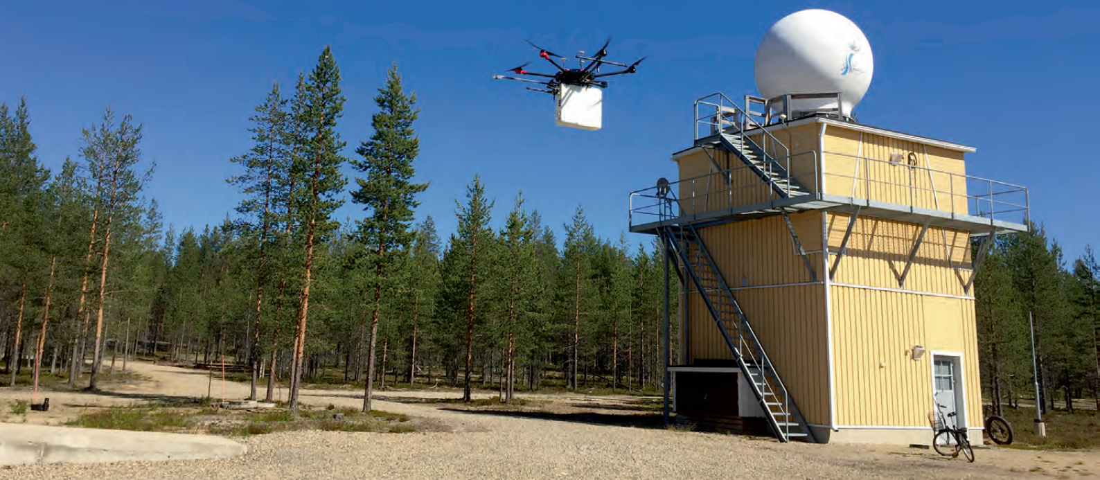
Kuva 2. Ilmatieteen laitos mittaa kasvihuonekaasuja AirCore-mittalaitteella Sodankylän mittausasemalla.
