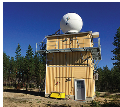
Kuva 2: TCCON asema Sodankylässä. TCCON on lähi-infrapuna-alueella toimivien Fourier-muunnos-spektrometrien verkosto, jonka tarkoituksena on tuottaa korkealaatuisia kolumnidataa hii- linien - ja lähteiden paikallistamista varten (Kuva: Rigel Kivi).
