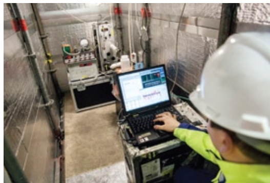
Kuva 2. Panu Karjalainen suorittamassa nanohiukkasmittauksia voimalaitoskattilasta tulevalle näytteelle. Kuva: Valtteri Hirvonen / Helen Oy.
