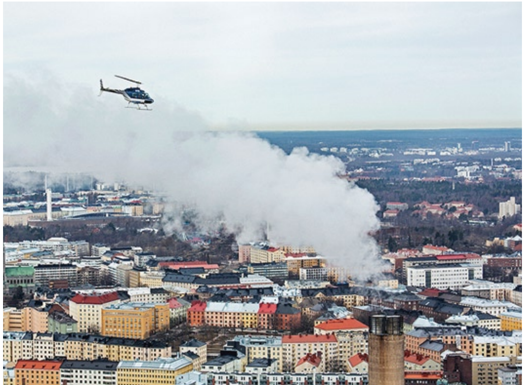
Kuva 1. Savukaasuvanan mittaus helikopteriin asennetuilla aerosolimittalaitteilla. Kuva: Valtteri Hirvonen / Helen Oy.
